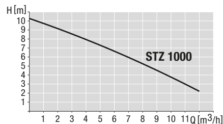
Fig. [5] Curve caratteristiche della pompa
